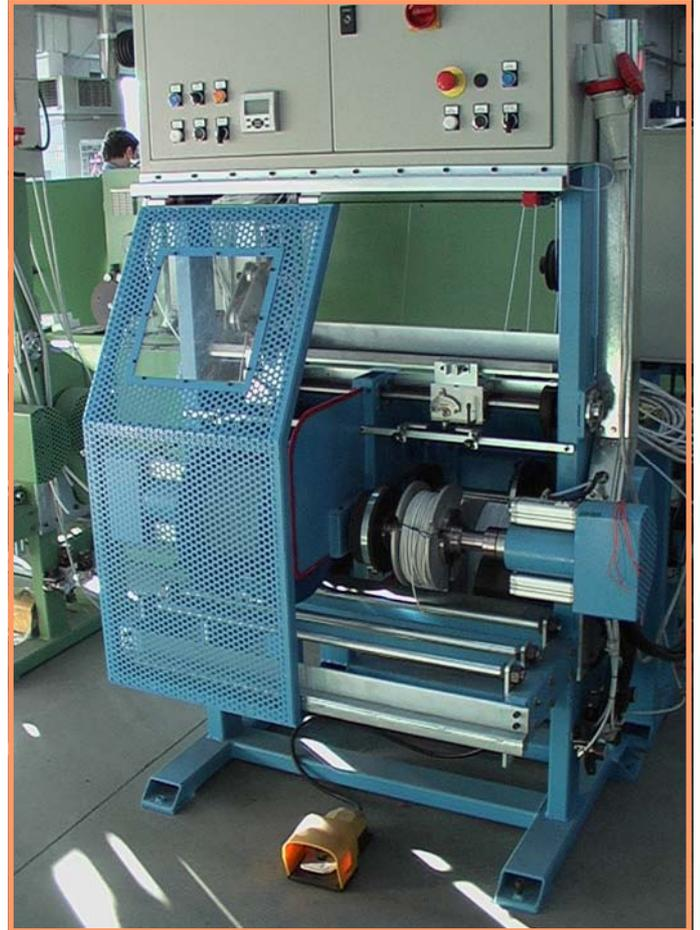
L'enrouleur type "AV 2X400 CA 300" permet la confection des bobines ou couronnes avec dimension max jusqu'à  $\varnothing 400 \times 200$  pour les bobines et  $\varnothing 400 \times 90$  pour les couronnes.
